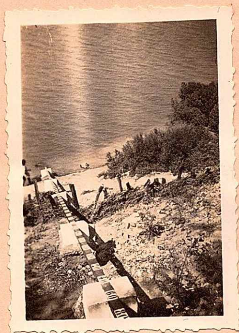
Echelle de MATAM A gauche l'évaporomètre semi-innervé
