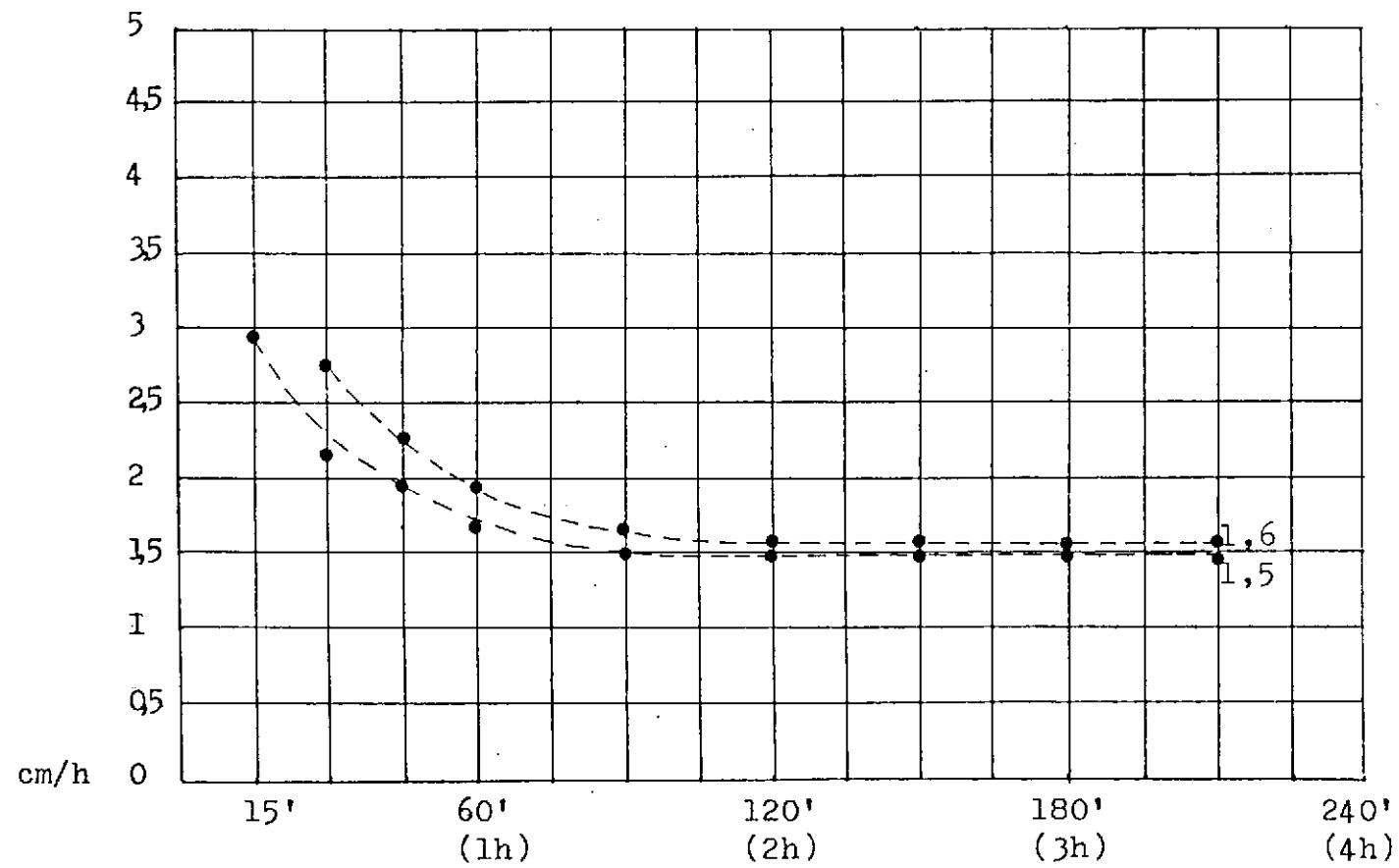
ESSAI D' INFILTRATION n° 8A,8B
