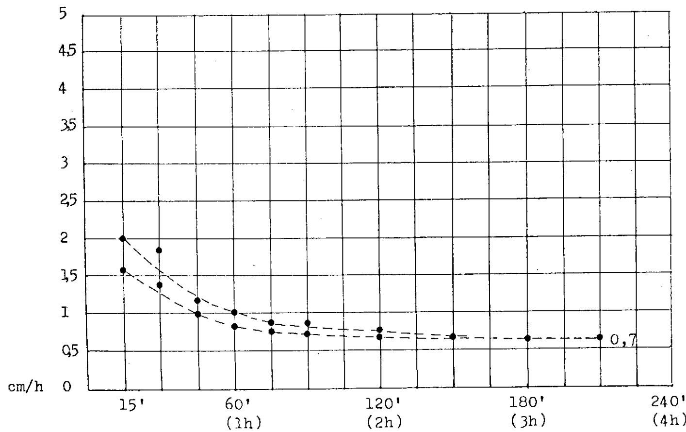
ESSAI D' INFILTRATION n° 9A,9B
