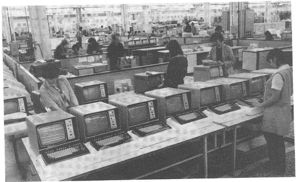
Fabrication de "display" d'ordinateurs à l'atelier d'informatique "Videoton".
