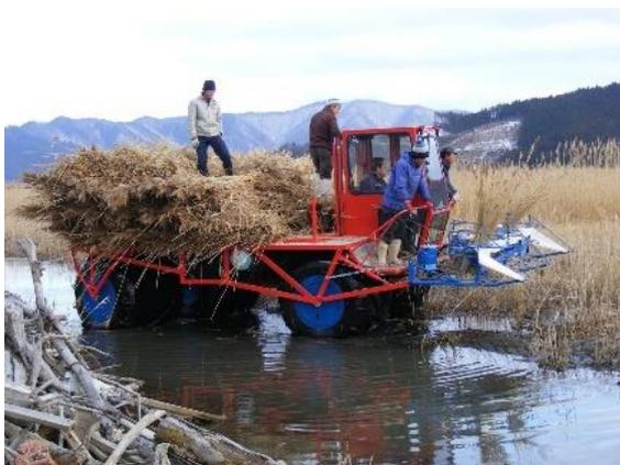
Figure 5. Moissonneuse de type SEIGA tout terrain
