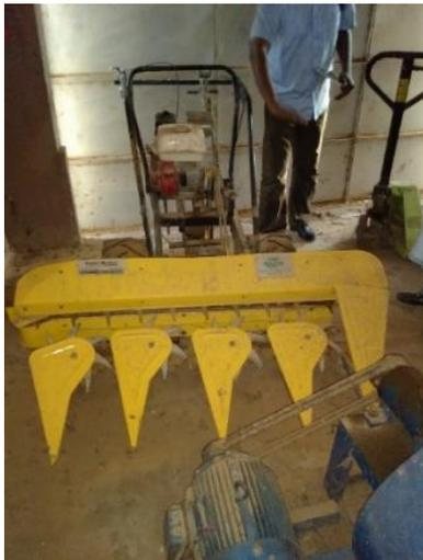
Figure 3. Motoculteur Tanta avec barre de coupe (photographié à l'ISET)
