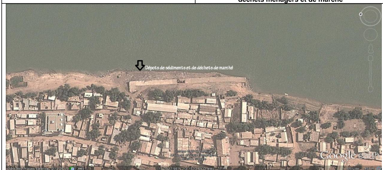
Figure 45: Présence de déchets tout au long du quai sur une bande de 20 m de large.
