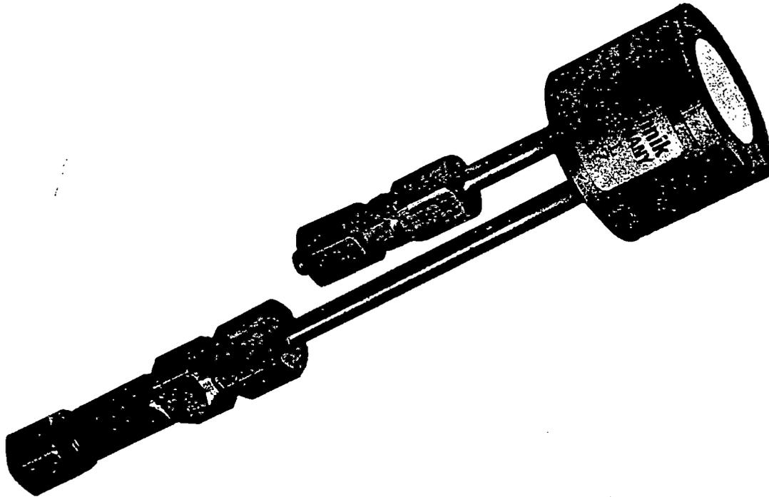
Les capteurs de pression interstitielle Glötzl, comme les capteurs de pression totale, fonctionnent sur le principe de la contre-pression (hydraulique ou pneumatique)
