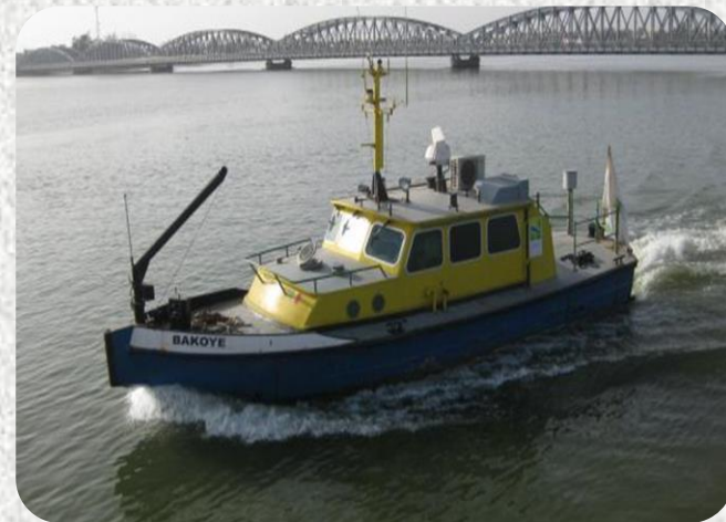
Vedette Technique BAKOYE (14,4 m X 3,75 m) Poids : 13 t – tirant d'eau : 1,25 m
