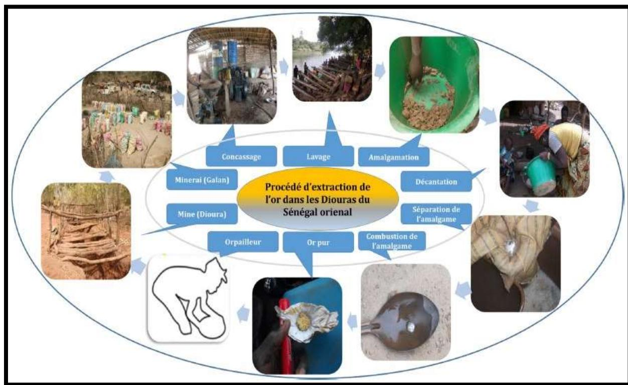
Figure 8: Les différents procédés d'extraction de l'or (Mall 2017)
