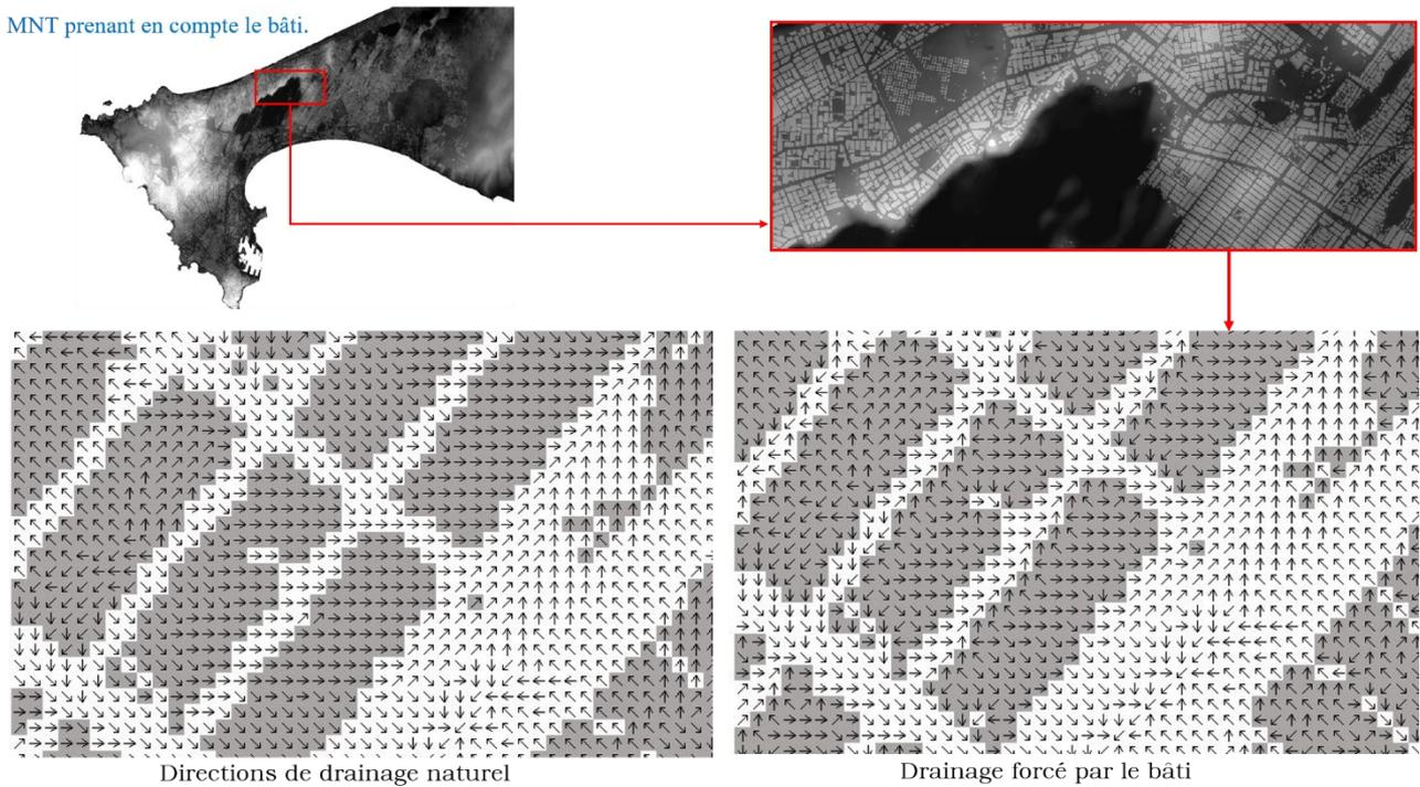
Figure 5 : Forçage des directions de drainage en fonction du bâti
