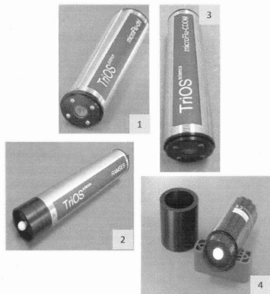
Figure 4 - Radiomètres TRIOS RAMSES pour la mesure in-situ des paramètres de qualité de l'eau (Acquis grâce à la subvention PAES/UEMOA) 1- Radiomètre hyperspectral TRIOS RAMSES-ARC (320 - 950 nm) ; 2- Capteur microFlu-Chl-a à fluorescence ; 3- Capteur microFlu-CDOM à fluorescence ; 4- Appareil de calibration spectrale de terrain
