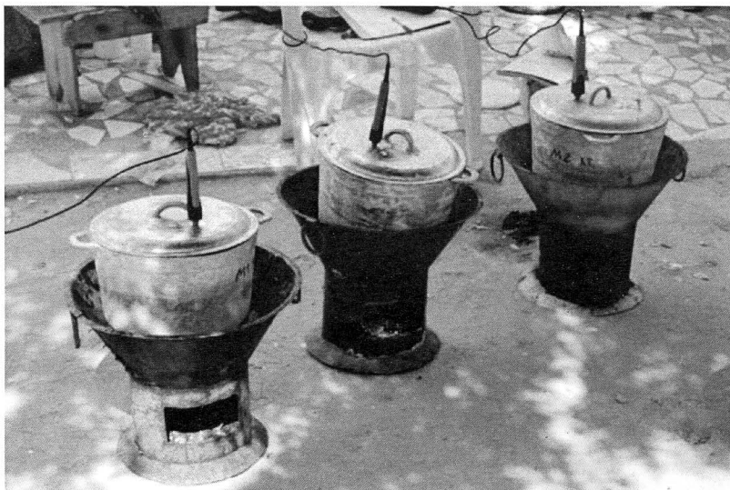
9. Foyers malgaches avec marmites et thermocouples lors d'un test de cuisine comparée
