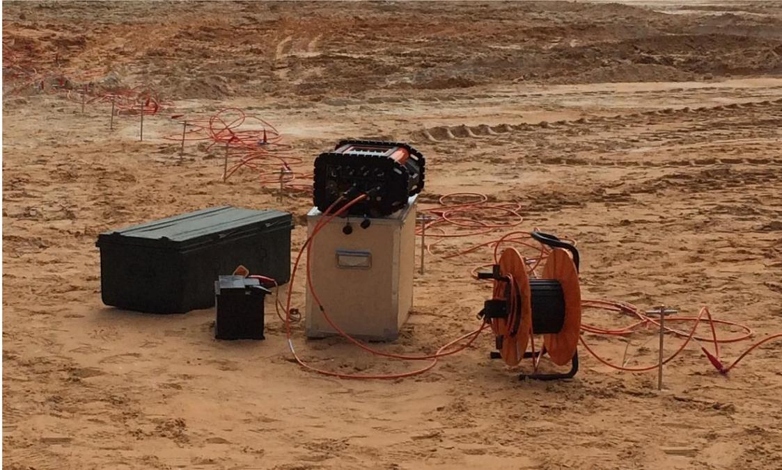
**Figure 3 – Acquisition de données de données au Résistivimètre Terrameter LS Lund.**
