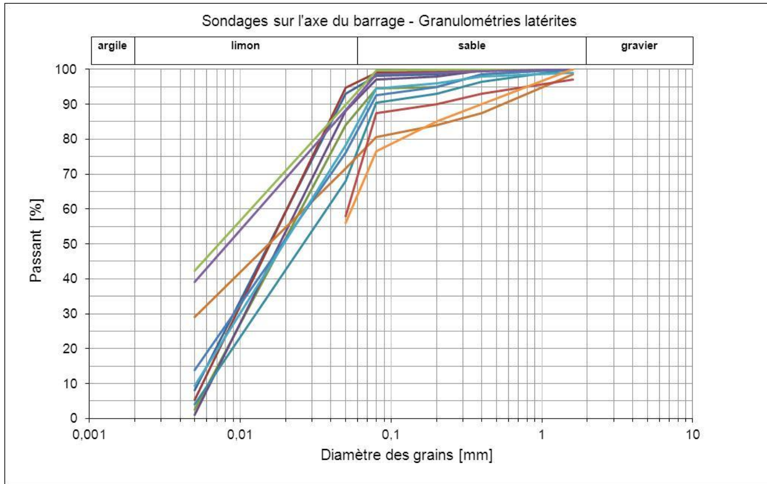
Figure A2. 33 - Zone de l'axe du barrage – Fuseaux granulométriques (profondeur échantillons de 6 à 27m)
