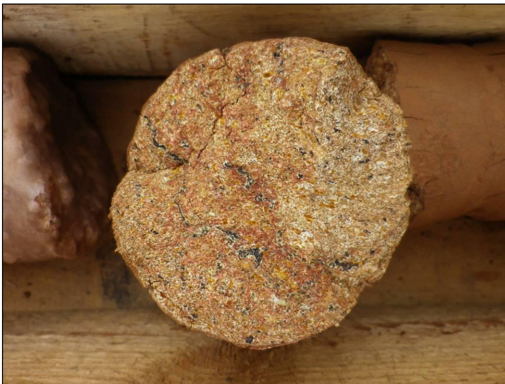
Figure A2. 24 - Niveau saprolitique dans le sondage S6 en rive gauche à la profondeur de 28m
