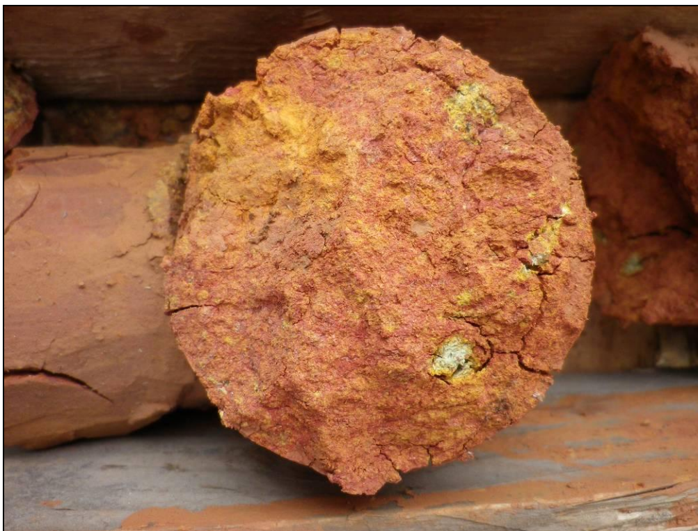
Figure A2. 23 - Niveau d'argile tachetée dans le sondage S6 en rive gauche à la profondeur de 18m
