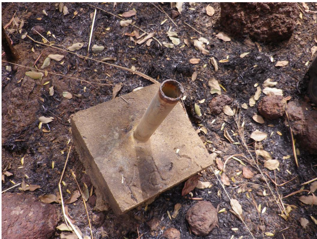
Figure A2. 30 – Campagne de reconnaissances d’Energoprojekt – Repérage du sondage Kd 50
