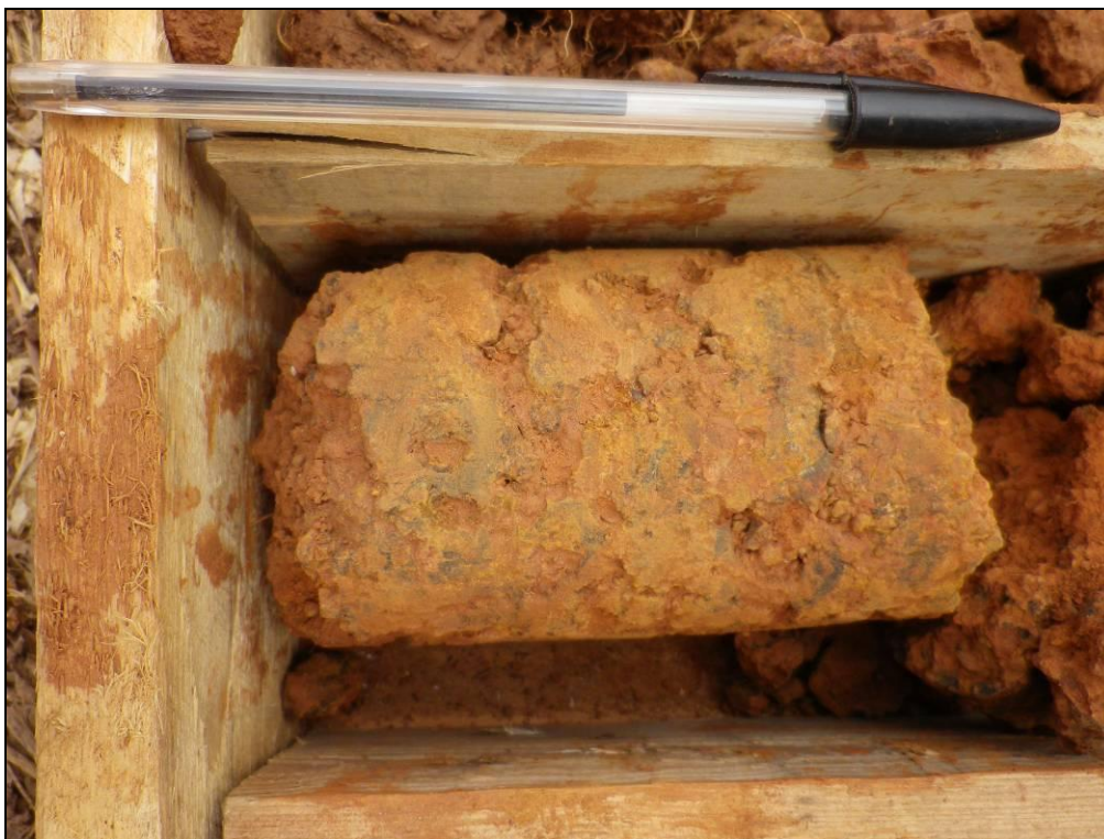
Figure A2. 22 - Horizon de cuirasse latéritique dans le sondage S6 en rive gauche à la profondeur de 2 m
