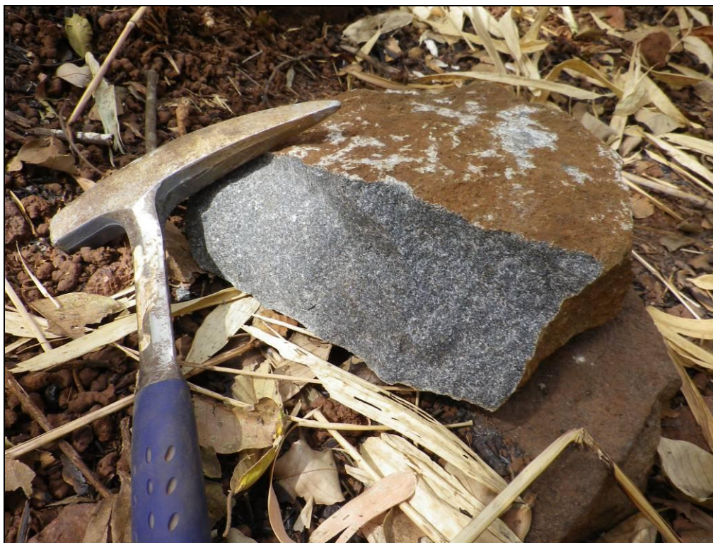
Figure A2. 19 - Bloc de dolérite en correspondance de la zone de carrière en RD
