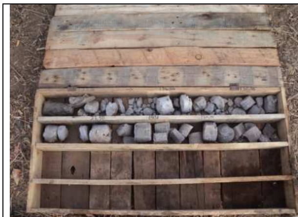
Sondage S2 - caisse 7 - profondeur de 31,50 à 40,50m
