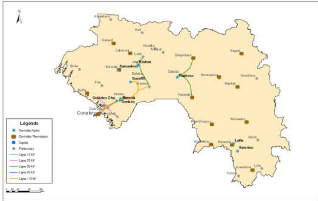
Figure 4-3 : Lignes de transmission existantes en Guinée (source : Ministère de l'Énergie et de l'Hydraulique en Guinée)
