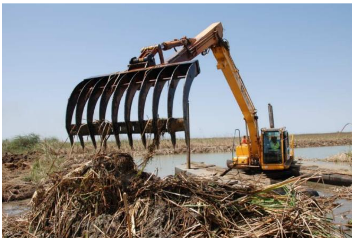
Figure 8. Dépôt de faucardage par un engin Bigfloat Rumo équipé d'une pelle à claire-voie (Eiffage, 2015)
