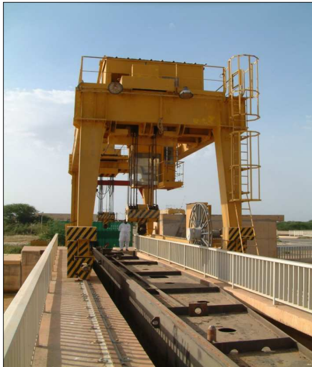
Portique de manœuvre du batardeau amont
