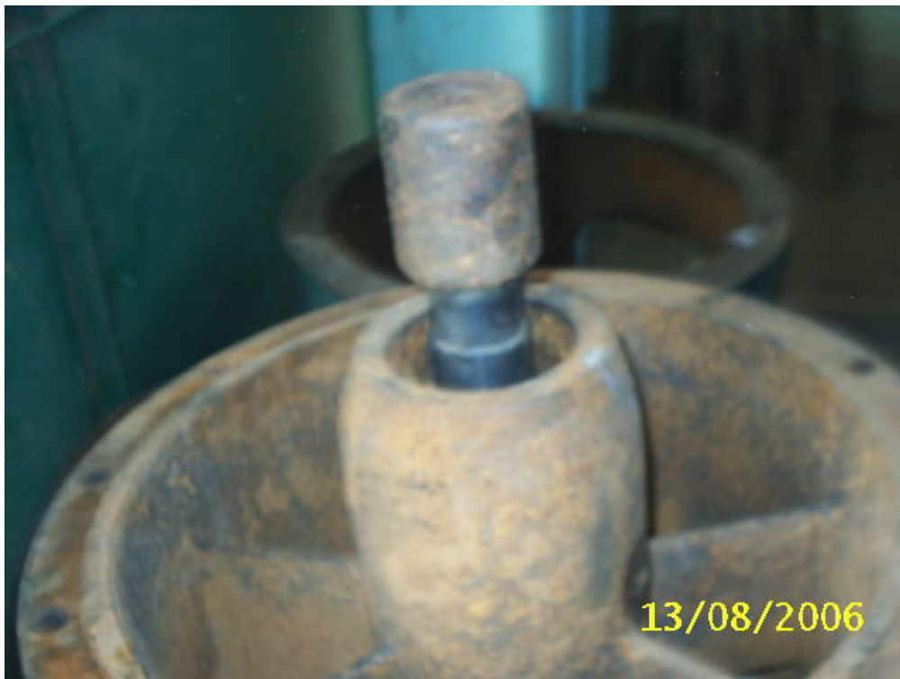
Corps de la pompe en cours de réparation
