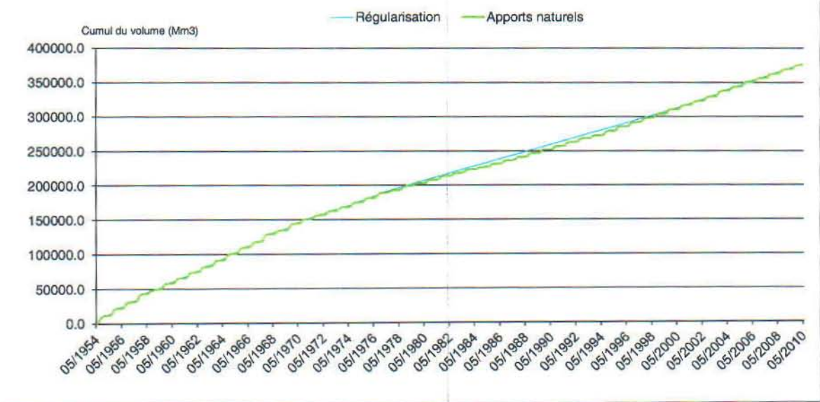
Fig. 6. SIMULATION DE REGULARISATION DES DEBITS DU BAFING A 240 M 3 /s (PERIODE 1954-2010) - VOLUMES
