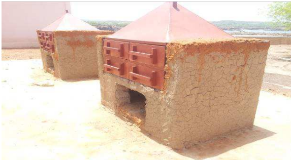
Fours à revêtement extérieur en argile
