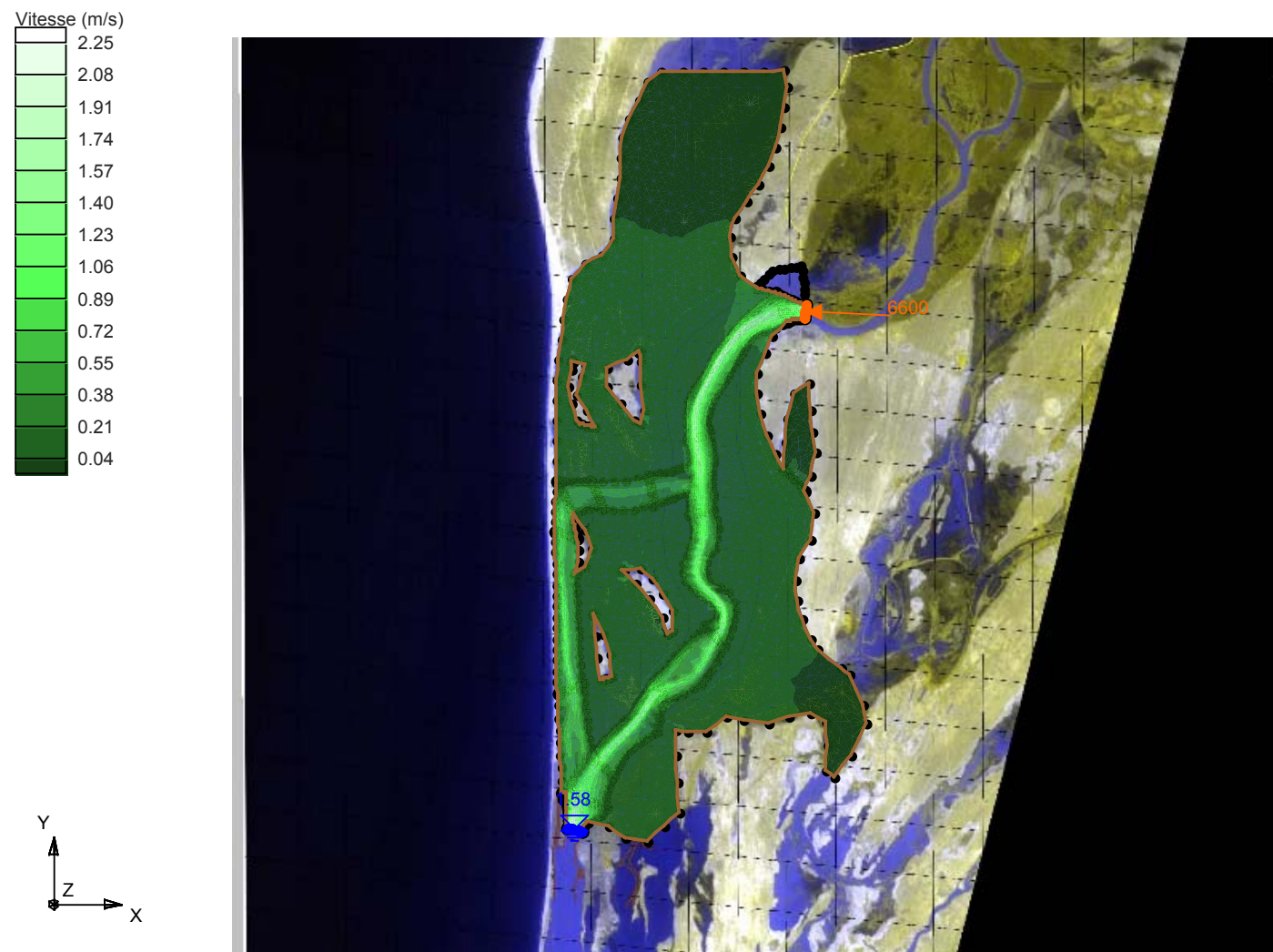
Figure 4-3 - Vitesse (m/s) – Modèle 2D pour Q = 6600 \text{ m}^3/\text{s}
