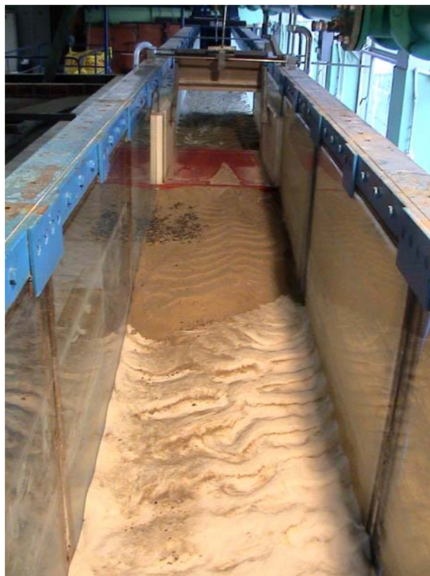
Figure 55: Cuvette d'érosion après Q = 6600 \text{ m}^3/\text{s} pendant 1 semaine – Vue longitudinale aval
