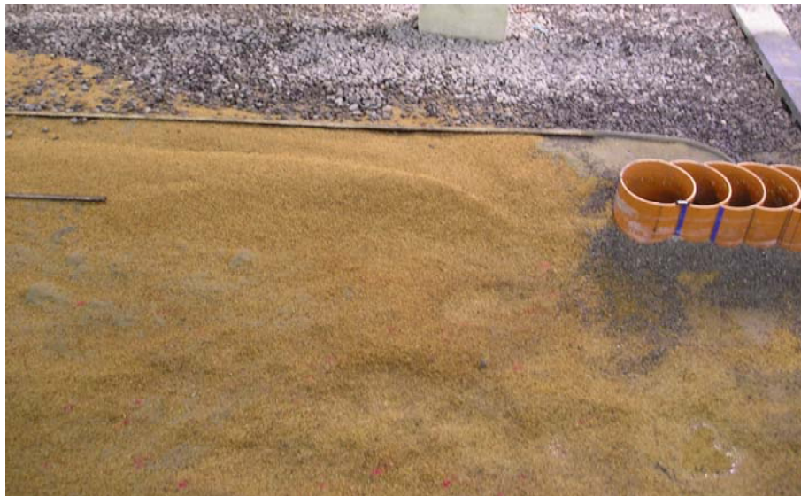
Figure 10 : Accumulation de sédiments au droit de la culée rive droite pour Q=6600 \text{ m}^3/\text{s}
