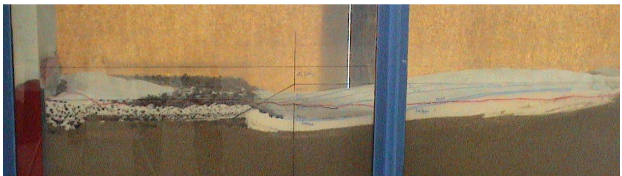
Figure 27 : Erosion du lit aval vue générale de profil Al(OH)_3 T=154 h
