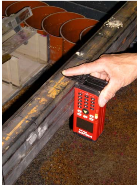
Figure 79 : Mesure de la fosse d'érosion au distance mètre laser
