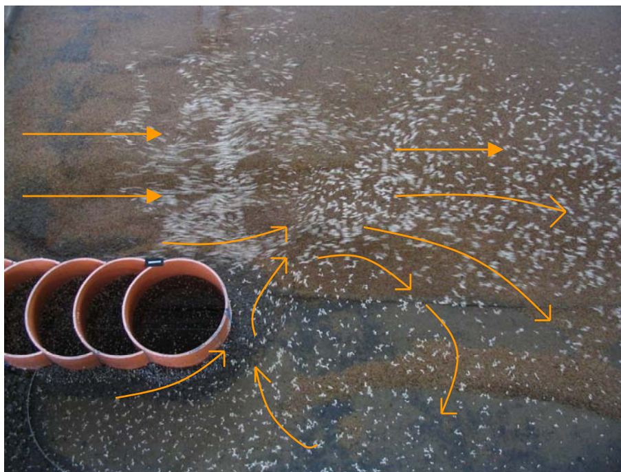
Figure 7 : Ligne de courant dans la zone aval de la culée rive droite – Q=1000 \text{ m}^3/\text{s}
