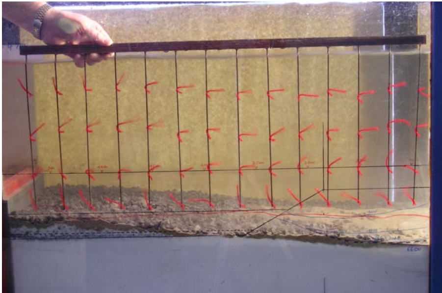
Figure 29 : Champ de vitesse en sortie de vanne
