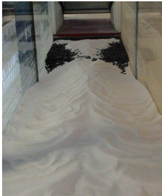
Figure 40: Cuvette d'érosion pour Q = 1500 \text{ m}^3/\text{s} pendant 1 semaine – Vue longitudinale aval
