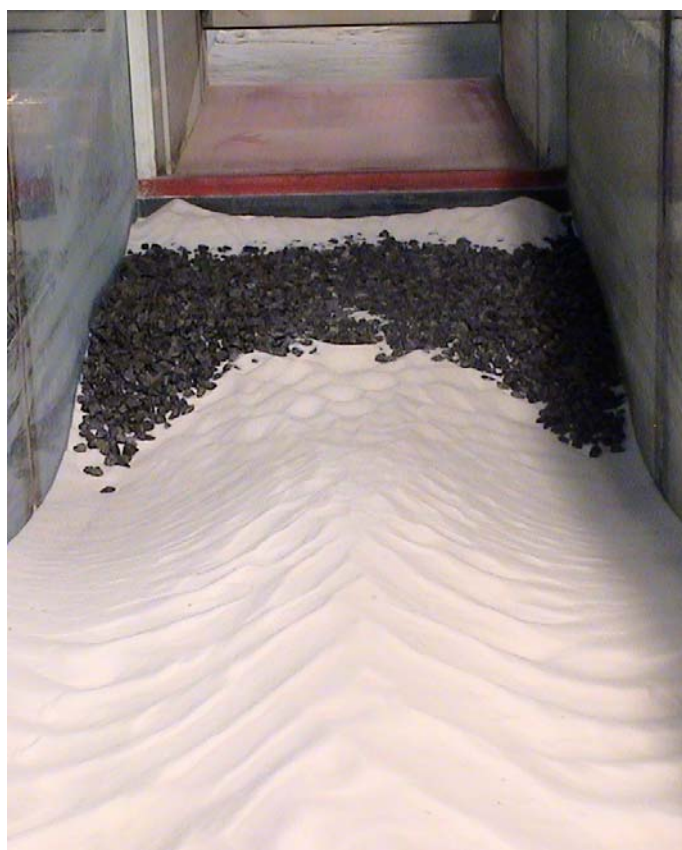
Figure 44: Cuvette d'érosion pour Q = 2000 \text{ m}^3/\text{s} pendant 1 semaine – Vue longitudinale aval
