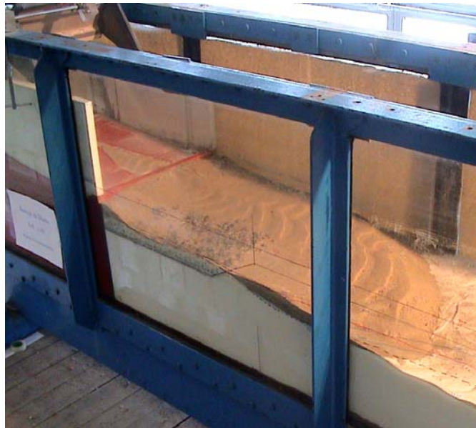
Figure 54: Zone des enrochements de protection Q = 6600 – Sédiments provenant de l'amont.
