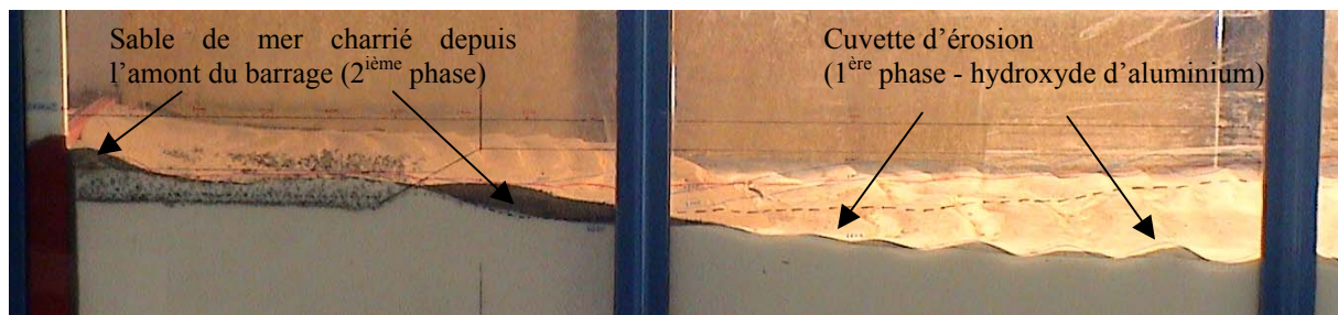
Figure 53: Cuvette d'érosion pour Q = 6600 m 3 /s pendant 1 semaine – Vue de profil rive droite
