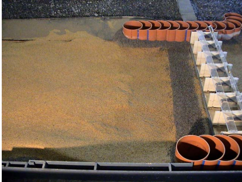
Figure 70 : Q = 3000 \text{ m}^3/\text{s} – Vue latérale rive gauche
