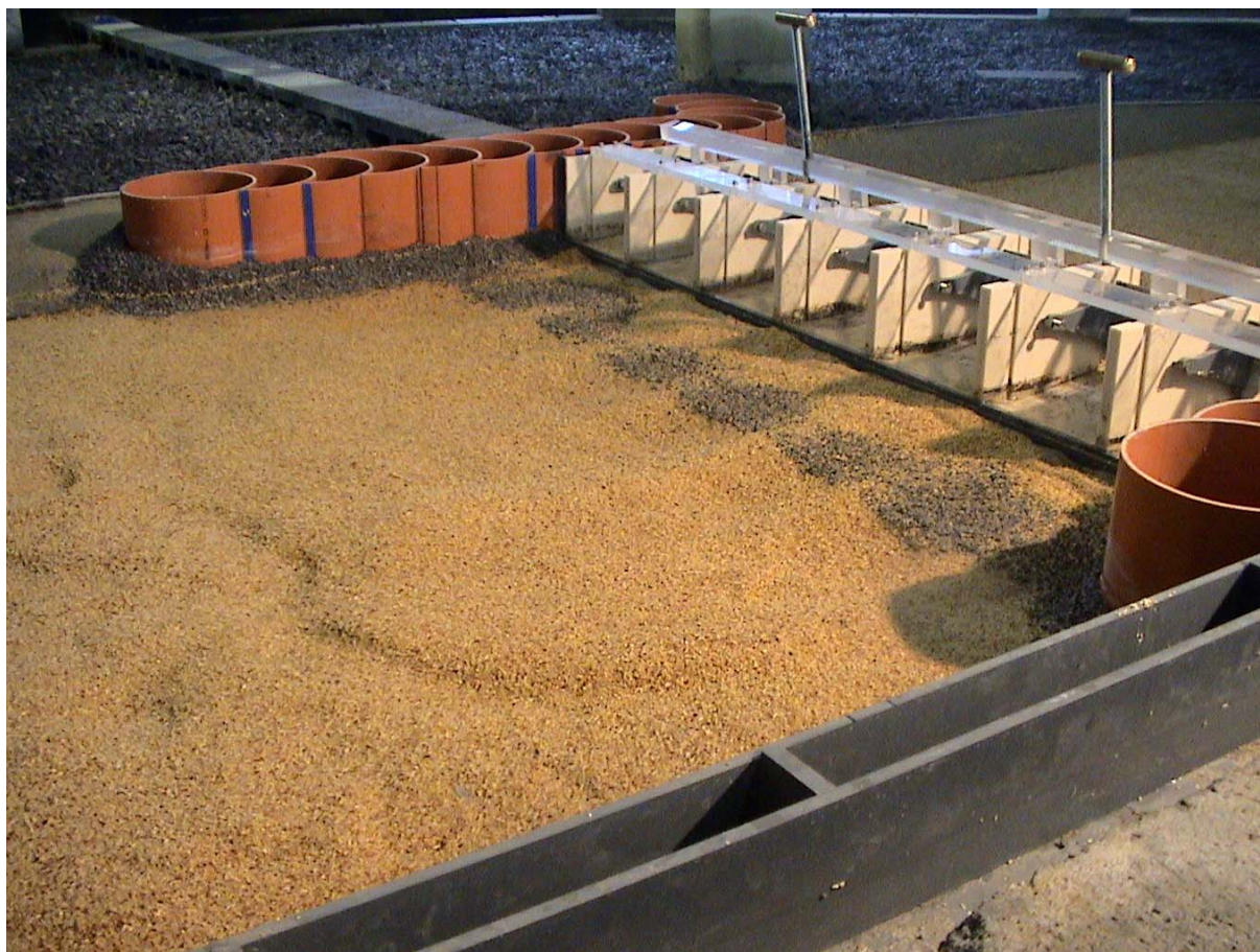
Figure 4 : Résultats des essais sur modèle 3D pour un débit de 1000\text{ m}^3/\text{s} .
