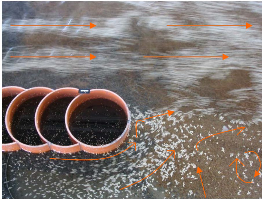
Figure 9 : Ligne de courant dans la zone aval de la culée rive droite – Q=6600 \text{ m}^3/\text{s}
