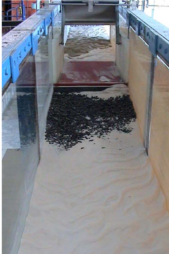
Figure 50: Cuvette d'érosion après Q = 4600 \text{ m}^3/\text{s} pendant 1 semaine – Vue longitudinale aval
