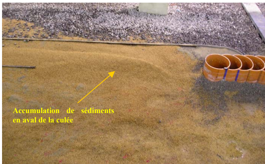
Figure 77 : Erosion pour Q = 6600 \text{ m}^3/\text{s} sans coffrage
