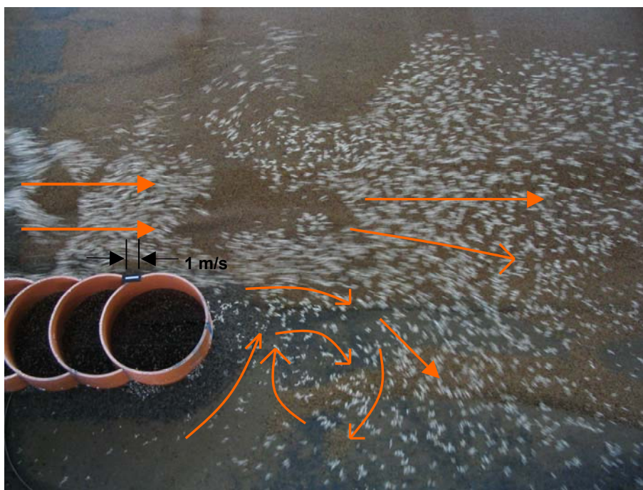
Figure 8 : Ligne de courant dans la zone aval de la culée rive droite – Q=2000 \text{ m}^3/\text{s}
