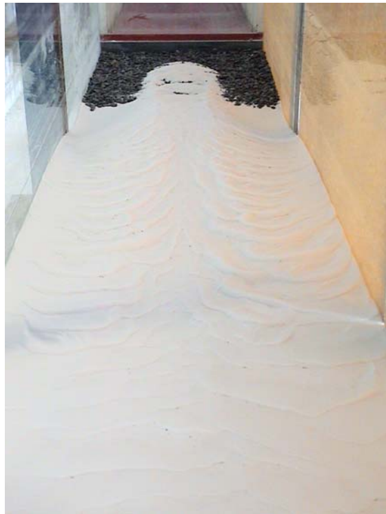
Figure 37: Cuvette d'érosion pour Q = 1000 \text{ m}^3/\text{s} pendant 1 semaine – Vue longitudinale aval
