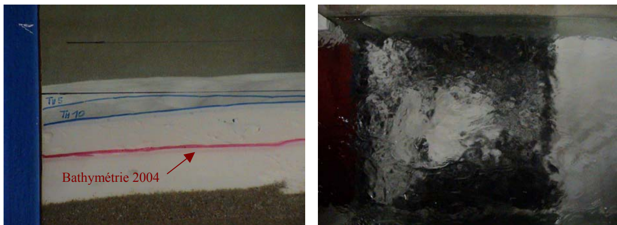
Figure 24 a et b : Erosion du lit aval - suite en aval de la figure 23 - et détail vue en plan de la zone de protection - Al(OH)_3 : T=70 h
