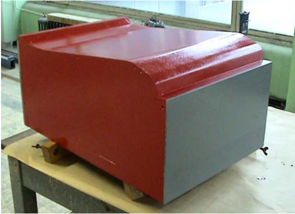
Figure 5 a et b : Vue du radier et de la vanne segment à l'échelle 1/49
